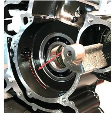
Gehäuse können aus produktionstechnischen Gründen in dem markierten Bereich sowie in der Bohrung des Pick-Up durch den Hersteller bearbeitet werden.
