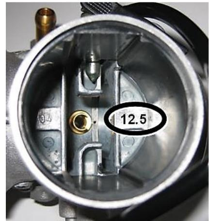
Bohrung des Vergasereinsatzes
