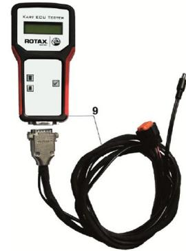
Die E-Box muss mit dem ECU Tester kontrolliert werden (Rotax no. 276230) entsprechend der folgenden Prozedur:
