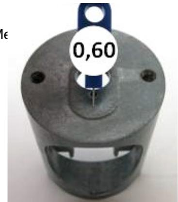
Vertikale Bohrung des Vergasereinsatzes
