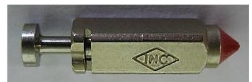
Die Nadel muss das Diamantensymbol sowie "INC" aufweisen.
